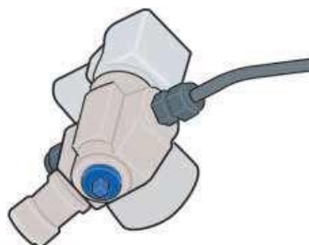
Supapă de închidere manuală la piciorul robinetului.
