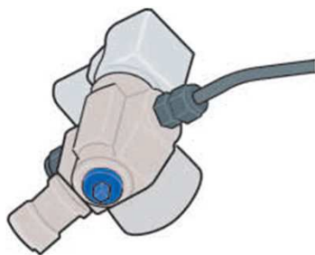
Supapă de închidere manuală la piciorul robinetului.
